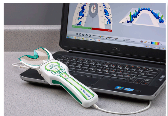
Система T-Scan Novus для цифрового аналізу оклюзії
